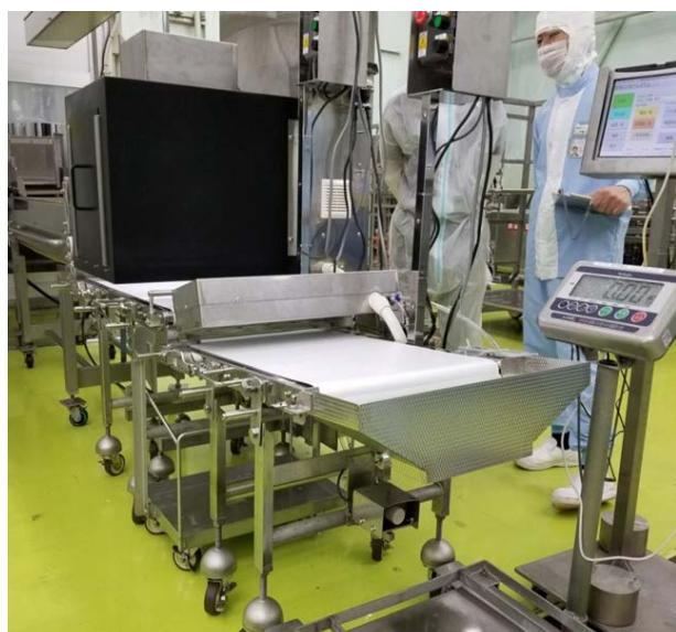
世界初の良品学習型AI原料検査装置現場導入1号機
