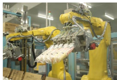
調味料製造における梱包工程の自動化 (キュービー神戸工場)
