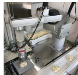
ポテトサラダの盛り付けロボット
