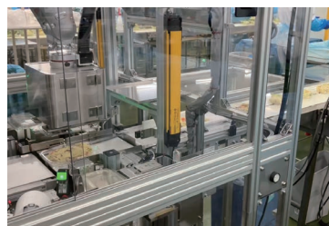
グループ惣菜工場稼働中の蓋閉めロボット
