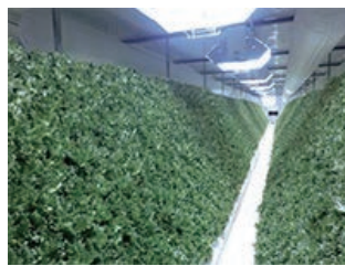
*キューピーが開発した植物工場。外界と遮断された環境で、人工光を利用し野菜を水耕栽培する。
