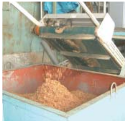
乾燥した汚泥( 挙母工場 )
