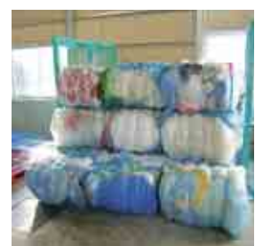
保管・運搬効率の向上のため、ポリエチレン袋を圧縮
