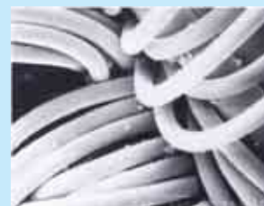
繊維に卵殻膜パウダーを配合させた新素材の拡大写真(電子顕微鏡写真600倍)
