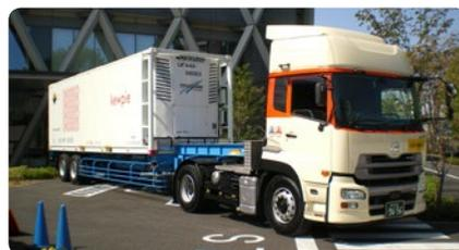
❷ 冷凍用コンテナのトレーラーヘッド
