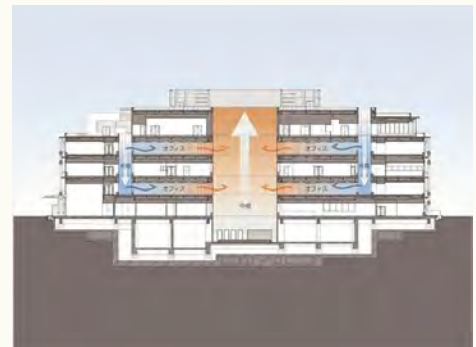
自然換気システム
