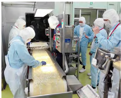
現場で作りあげたAI原料検査装置(キューピー鳥栖工場)
