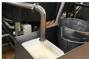
製品の切り替え時などに、配管などからマヨネーズの廃棄物が出る
