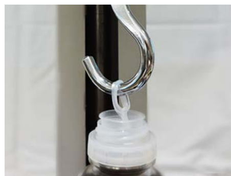
ドレッシングのプルリングを引っ張り、同様に、開封しやすさを評価します。
