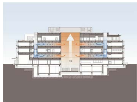
自然換気システム
